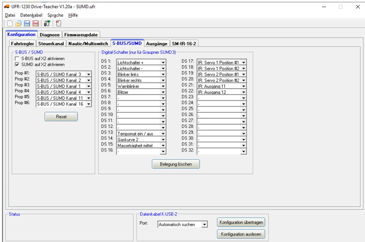
Soll ein Summensignal des Empfängers ausgewertet werden, kann dies hier aktiviert werden. Der Summenkanal des Empfängers wird mit X2 (Prop #2) des UFR-1230 verbunden. Die einzelnen Kanäle des Summensignals können hier den Prop.-Kanälen des Fahrtreglers zugeordnet werden. Weitere Informationen zu den Summensignal-Einstellungen finden Sie auf Seite 24.
