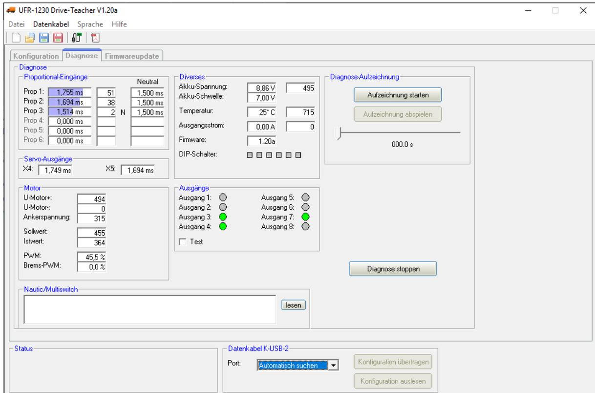
Im Drive-Teacher ist eine Diagnosefunktion integriert, mit deren Hilfe verschiedene Funktionen des Fahrtreglers überprüft werden können. Dazu muss das Datenkabel [K-USB-2](#) an den Fahrtregler an X6/1 (unten) angeschlossen werden.
