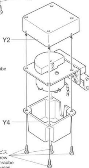
★図の状態まで部品を外して各ユニットを取り付けます。
