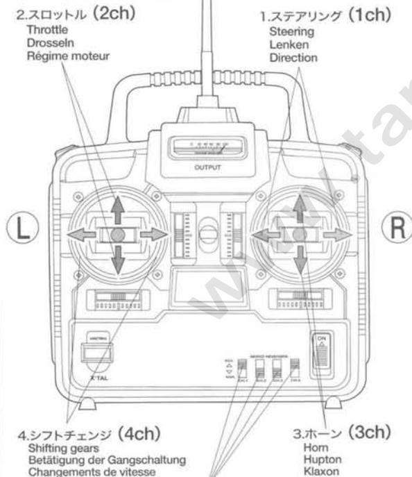
※FUTABA製アタック4WDをご使用の場合、1chと4chはREV. (リバーブポジション) の位置で使用します。
